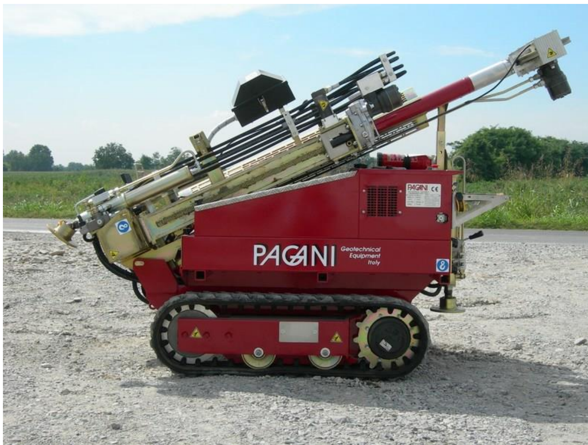
Slika 2: Dinamični penetrometer TG 63-100
